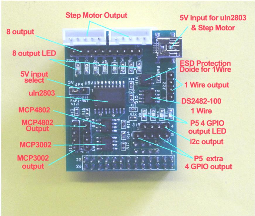
1. J2 J3 Step motor connector J2 (5V,D0,D1,D2,D3) J3(5V,D4,D5,D6,D7) can use Step motor (28BYJ-48 5VDC)
